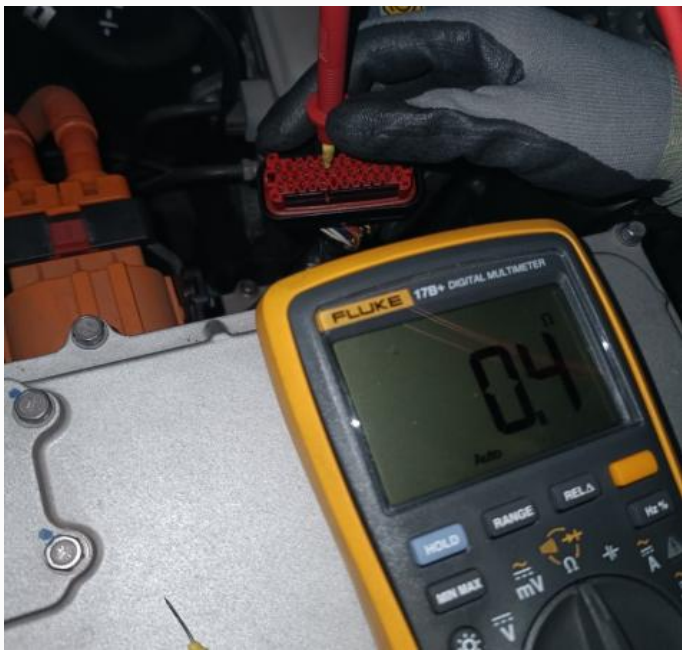
图38 电机控制器线束端子19对地电阻检测
