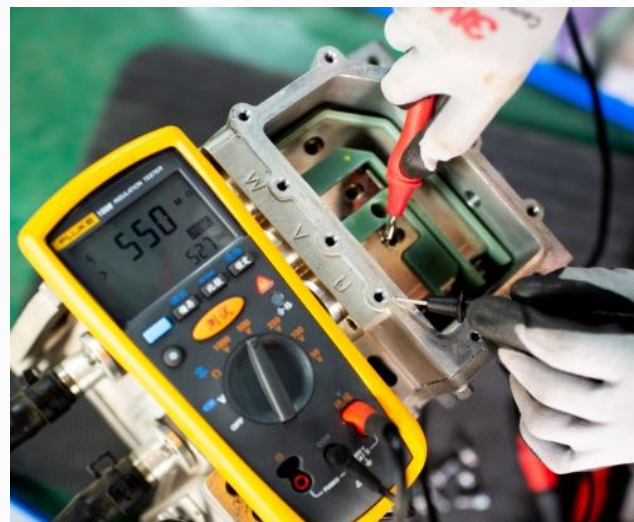
图40 起动机的U相绝缘电阻值检测
