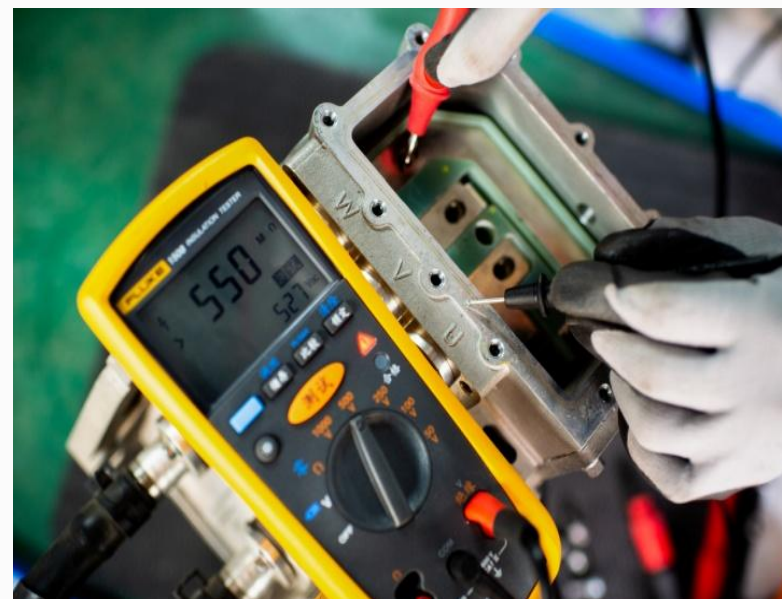
图42 起动机的W相绝缘电阻值检测
