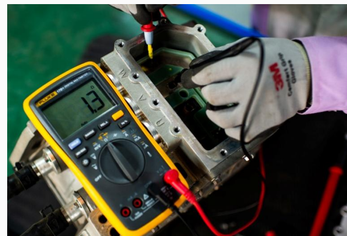
图32 起动机V-W相电阻检测
