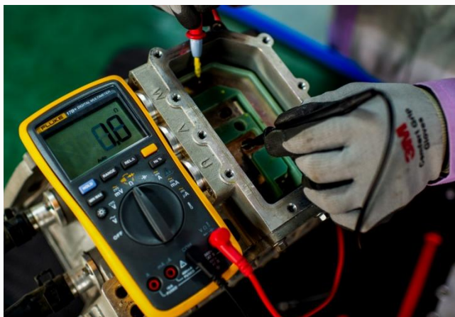
图31 起动机U-W相电阻检测
