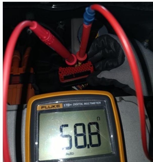
图39 检测CAN线电阻值
