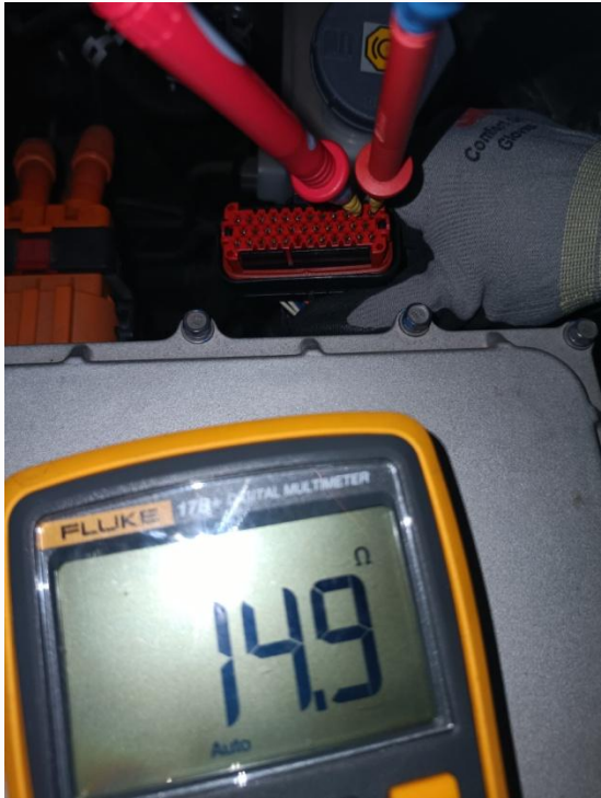
图35 旋变传感器的励磁绕组检测
